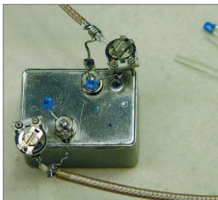
Bild 17: Anpassung eines Quarzfilters mittels Serieneinstellwiderständen zur Grobabschätzung des Realteils der Filterimpedanz; die Kondensatoren dienen zur Verringerung der Welligkeit im Durchlassbereich.
