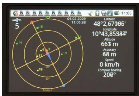
Bild 2: GPS-Status zeigt Zahl und Orte der empfangbaren GPS-Satelliten sowie die genaue eigene Position (Breite, Länge, Höhe).
