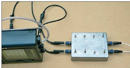
Bild 1: Mit einem Schleifenkoppler lässt sich die Energie der Resonanzschleife ohne weitere Verstärkung der Ferritantenne des Empfängers zuführen.
