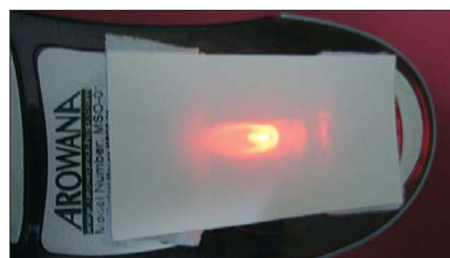
Bild 5: Die Membran überdeckt den Lichtstrahl der Maus.
