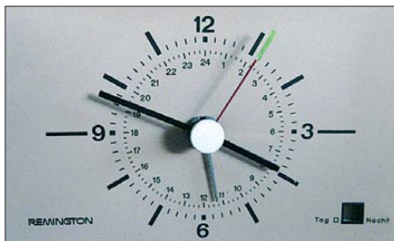
Bild 8: Netzfrequenzabhängige 50-Hz-Synchronuhr mit Leuchtfolie auf dem Zeiger
