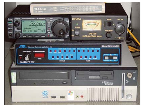
Gerätschaften der AMTOR-Mailbox in Peine, die auch weiterhin auf 3590 kHz arbeitet. Foto: DL0PE
