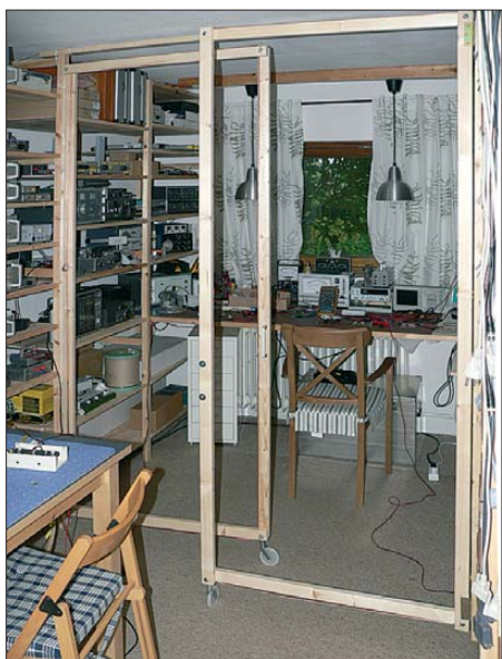
Bild 14: Selbst bei beengten Platzverhältnissen lassen sich für den Empfang niederfrequenter Aussendungen Schleifenantennen einsetzen. Hier wurden zwei Exemplare eingesetzt, um den Phasenbetrieb zu ermöglichen. Fotos: DG9WF
