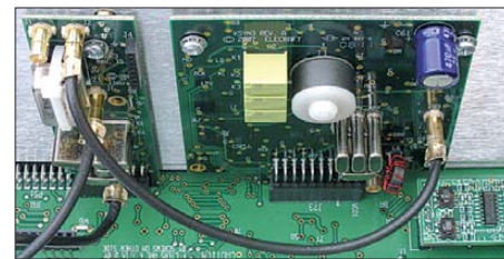
Bild 6: Links an der Montageplatte hinter der Frontplatte der Referenzoszillator KREF3 mit dem TCXO, rechts der Synthesizer KSYN3, unten rechts der 1. Mischer
