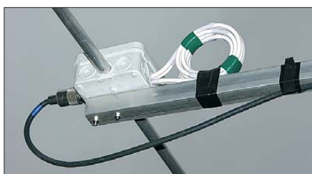
Bild 12: Aufgewickelte 6-m-Drossel außerhalb der Anschlussdose
