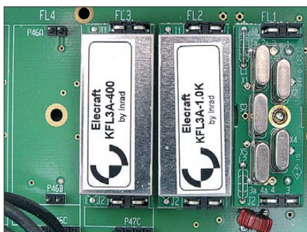
Bild 7: Die Roofing-Filter – Seele des K3. Bei den fünfpoligen sieht man die Quarze, die achtpoligen haben ein Metallgehäuse.
