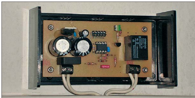
Bild 1: Betriebsbereiter Klingel-Türöffner-Automat Version II (KTA-II) im geöffneten Gehäuse
