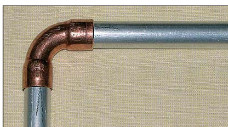
Bild 11: Eckverbindung mit Kupferrohr-Fittings (Baumarkt) bei der 6-m-Antenne
