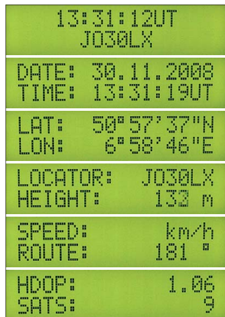
Bild 3: Die verschiedenen Anzeige-Modi lassen sich mit dem Taster S1 wählen.
