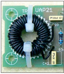
Bild 13: Zur Schleifenauskopplung, hier beispielhaft ein Teil der Platine UAP21 [12], lässt sich der Schleifendraht ein- bis zweimal durch den Ringkern führen.
