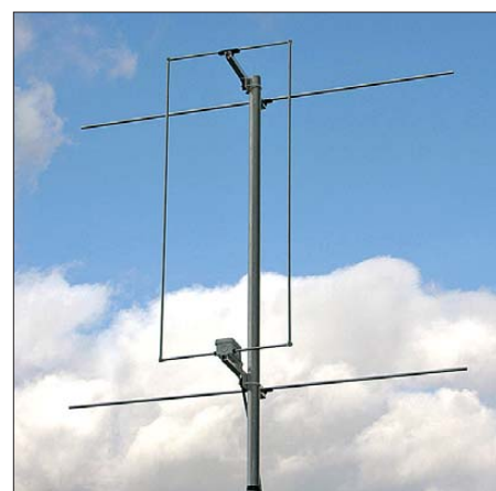
Bild 5: Fertig aufgebautes 2-m-Quadlong
